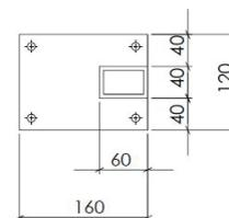
Montageempfehlung der Bank SOFT/EDGED mit V4A Tragkonsolen. Maßangaben sind Nennmaße. Maßangaben in mm.
